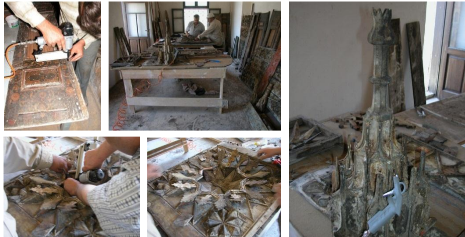
٢٠- تثبيت الخشب ببعضه عن طريق مسامير شعرية فولاذية والغراء النباتي
